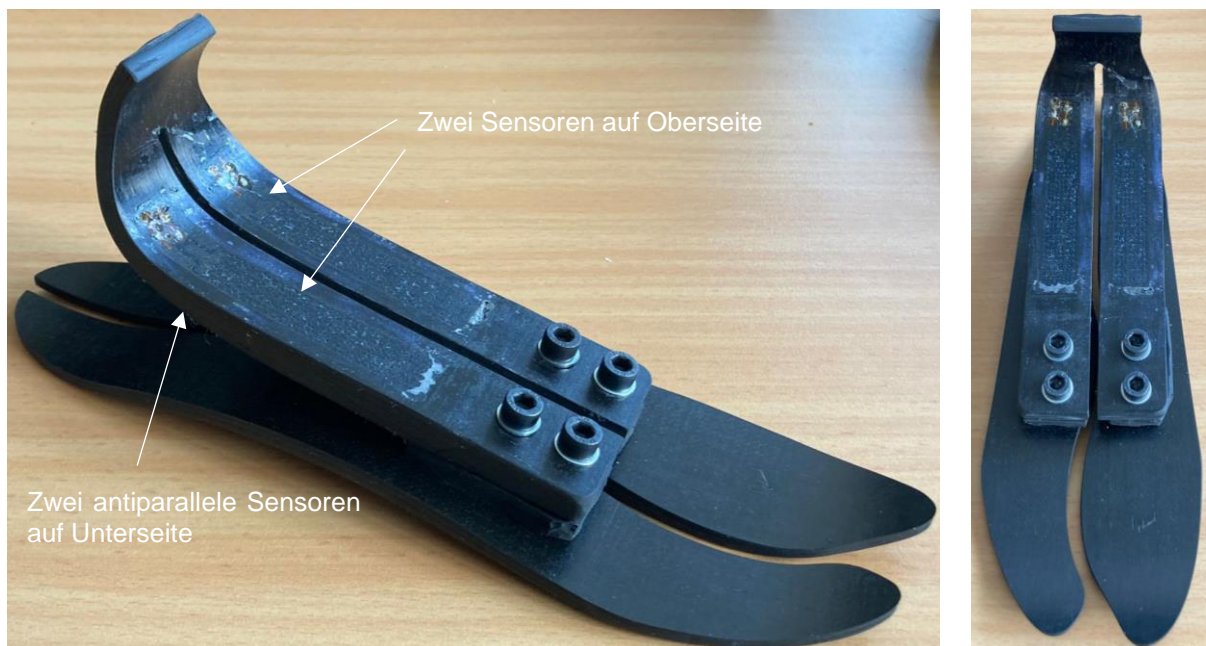
Abbildung 9: Prototyp des CFK-Prothesenfußes mit integrierter Sensorik
